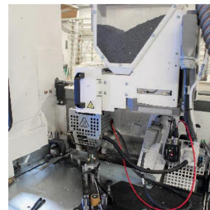
/ Mit Verleimteilen für EVA, PUR oder Laserkanten auf alles vorbereitet. Im Bild das Schmelzkleber-Verleimteil.
