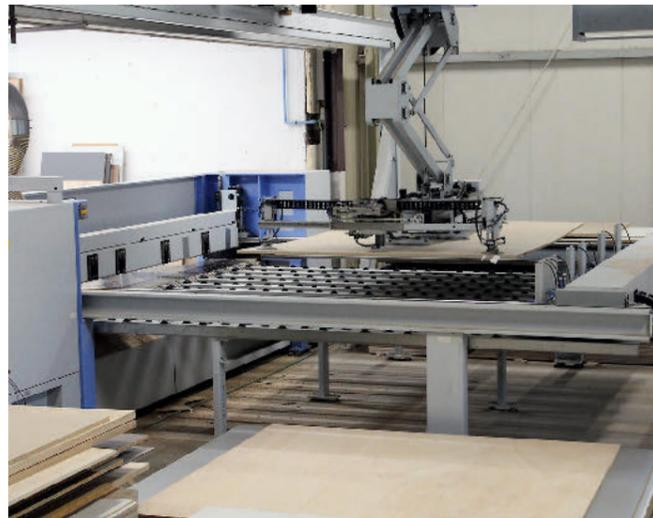
/ Manipuliert automatisch nach Programm: Der Manipulator fördert die Platten auftragsweise direkt auf die Säge.
