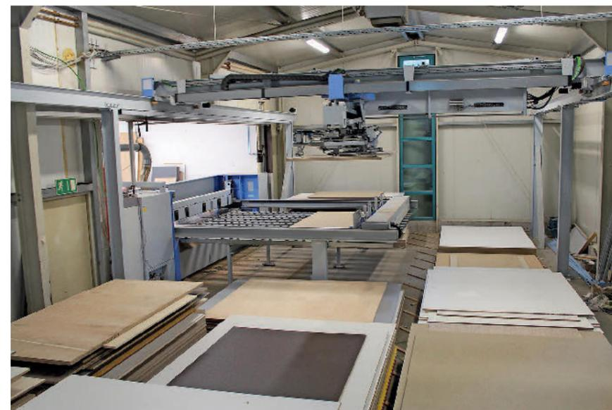
*Hier geht's los: Im automatischen Plattenlager TLF 211 von Homag sind Plattenhalbformate chaotisch gelagert. Außerhalb der Arbeitszeit wird auftragsweise vorgestapelt.*
