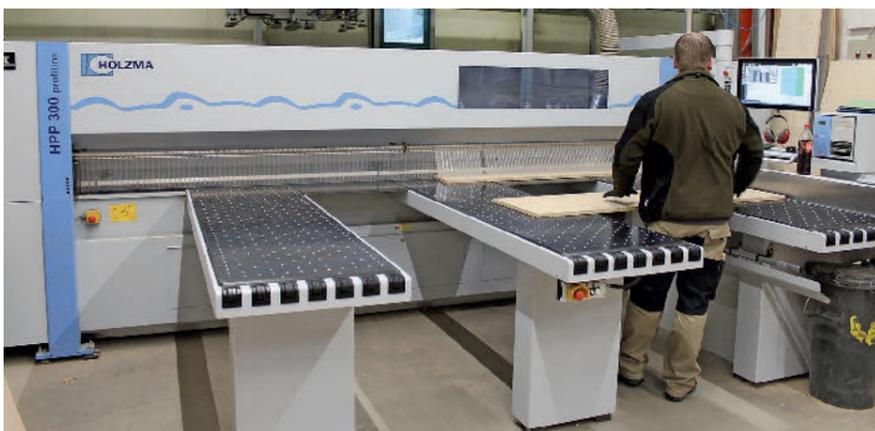
/ An der Plattenaufteilsäge HPP 300 Profiline erhält jedes Teil einen QR-Code zur Teileidentifizierung an den weiteren Fertigungsstationen.
